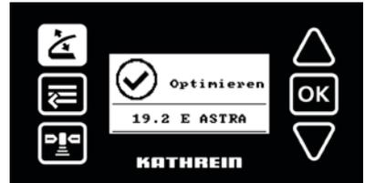
⇒ Nach einer erfolgreich abgeschlossenen Satellitensuche erscheint die Anzeige rechts. Es werden der gefundene Satellit, die Signalstärke und Signalqualität angezeigt.
